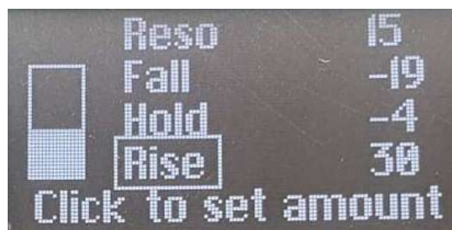
Écran Macro Assign pour parcourir les emplacements de modulation. L'emplacement actuel est encadré.
